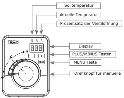
Der Stellantrieb EU-STZ-180 RS wird mit einem Adapter für die einfache Montage auf einem Drehmischventil geliefert.
