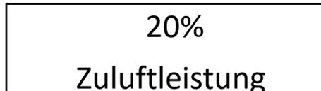
Hier stellt der Kunde die Leistung der Ventilatorarbeit im Modus **manuelle Arbeit** ein. Ein Druck auf die Taste **OPTIONEN** schaltet die Zuluft ein. Die Zuluft arbeitet bis zum erneuten Druck auf die Taste **OPTIONEN**.
