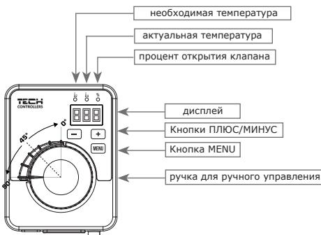
Привод EU-STZ-180 RS поставляется с адаптером, который позволяет легко установить его на поворотный смесительный клапан.
