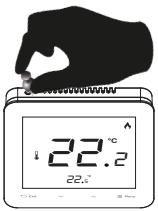
Утримання кнопки реєстрації на контролері протягом кількох секунд приведе до синхронізації, а зміна заданої температури в головному контролері одночасно змінить її в контролері. Без синхронізації зміна заданої температури в контролері приведе до зміни в контролері з тимчасовою затримкою.
